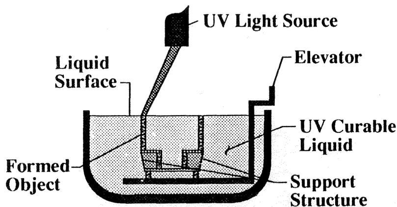
Figure 1: Stereolithography Apparatus (SLA)
