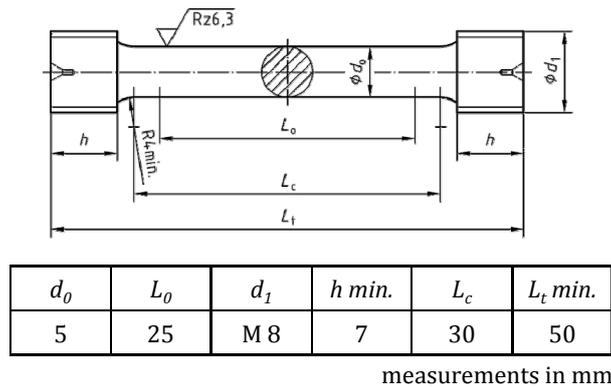
**Fig. 1:** Tensile specimen DIN 50125 - B 5 x 25 [7]
